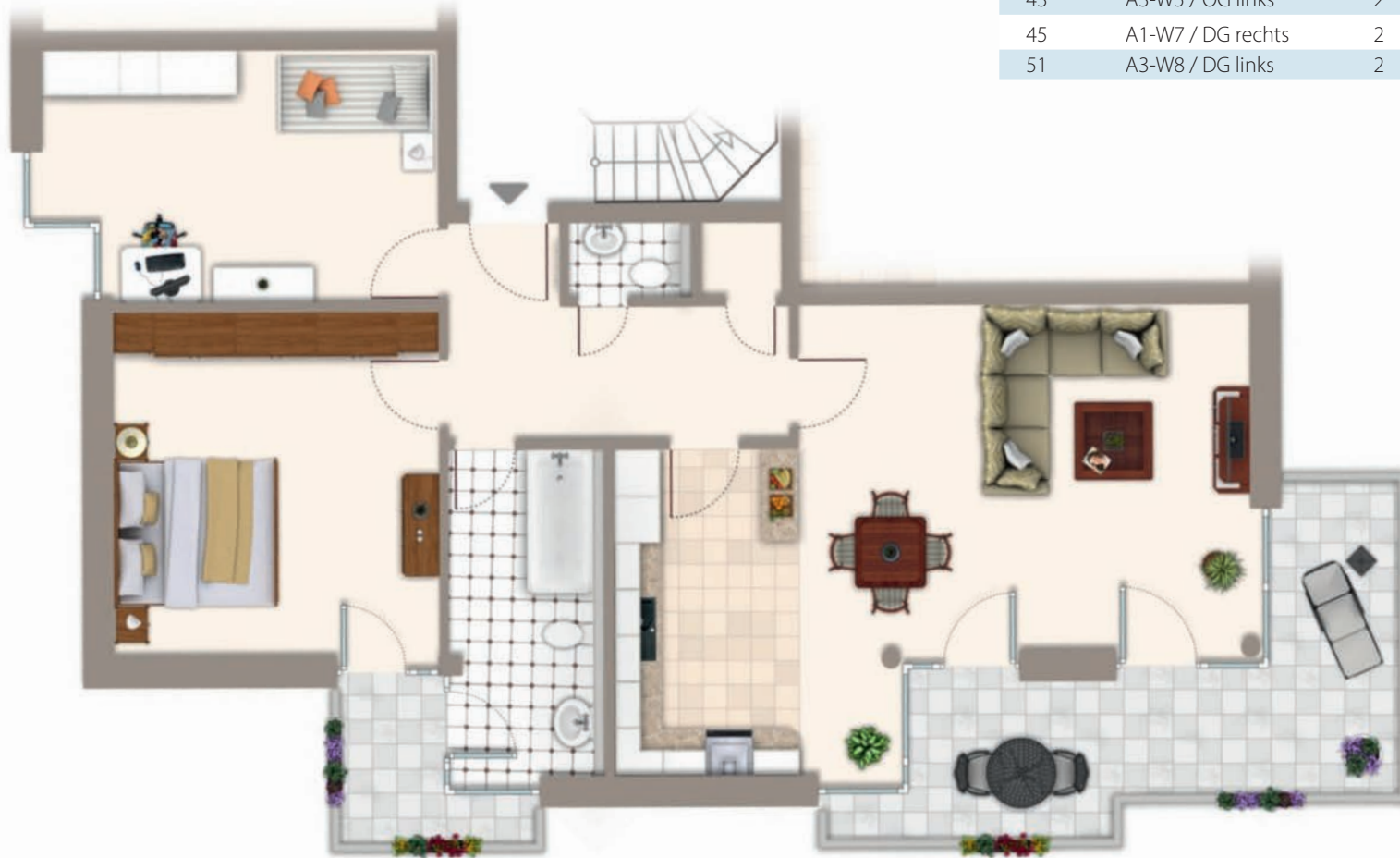
Grundrisstyp A-A / 3-Zimmer-Wohnung, Küche offen zum Wohnraum, Tageslichtbad mit Wanne, Gäste-WC, AR in der Wohnung, 2 Balkone Die Möblierung ist beispielhaft und nicht im Kaufpreis enthalten. Die Grundrisse sind nicht maßstabsgetreu.
